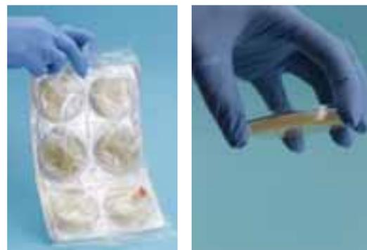
Figure 3. **Boîtes de contact TSA** (Réf. 271114ZI). Le milieu est appliqué sur la surface en vue du recueil d'un échantillon de l'environnement. L'emballage unique spécial sous blister permet l'utilisation d'une seule plaque à la fois.
