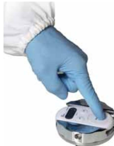
Applicateur de boîte de contact pour la standardisation de la pression des boîtes de contact sur les surfaces (Réf. 710-0961).
