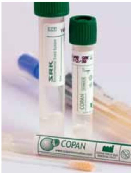
Écouvillons pour le contrôle environnemental dans une enveloppe triple-protection pour salles propres (Réf. 300-0228).
